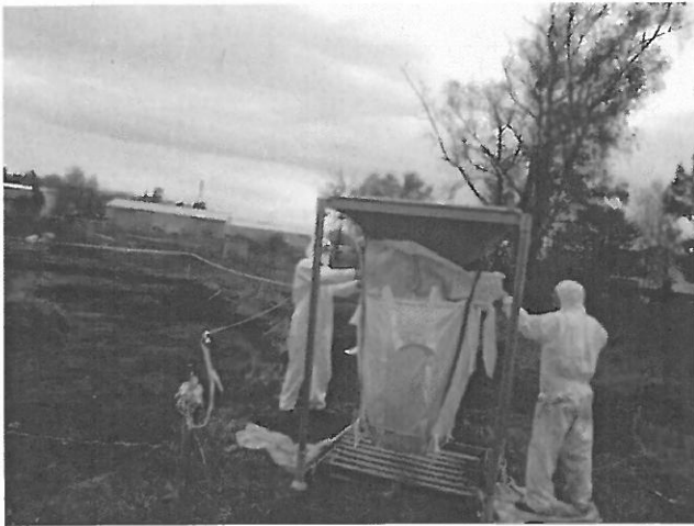
Mise en place du big-bag sur la trémie
